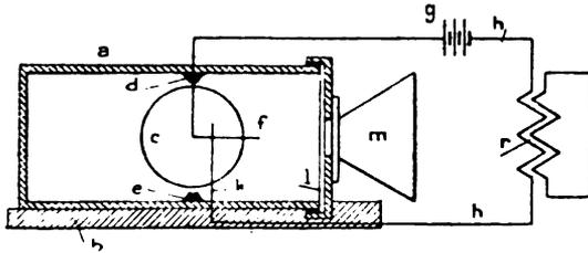
Girando il disco, la leva *f* può toccare il contatto verticale *k*, dal quale parte un conduttore *h*, che si reca all'altro polo della pila, passando pel primario di un rocchetto *r* formante parte di un dispositivo di accensione elettrica. Si ha così il mezzo di chiudere il circuito elettrico e produrre l'accensione.
