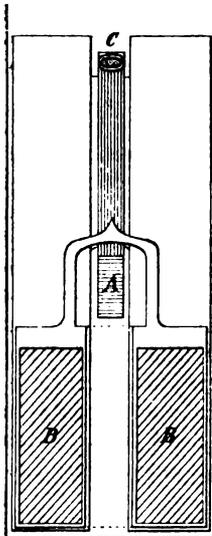
figura. *A* è il fulminato di mercurio, *B* un innesco cilindrico di acido picrico, protetto superiormente da un robusto diaframma metallico; fino
