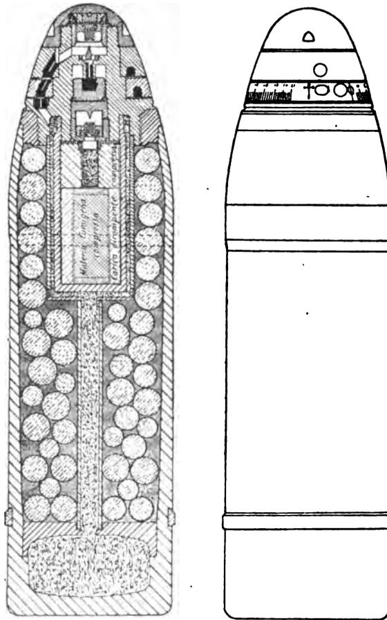
come normali per gli shrapnels con carica posteriore. Nel tiro a percussione per contro lo shrapnel dirompende presenterebbe tutti i vantaggi della granata carica di potente esplosivo: nell'urto contro un ostacolo la spoletta determina lo scoppio del proietto ed in pari tempo si sviluppa una densa nube di fumo. L'apertura del cono di dispersione, nel tiro a
