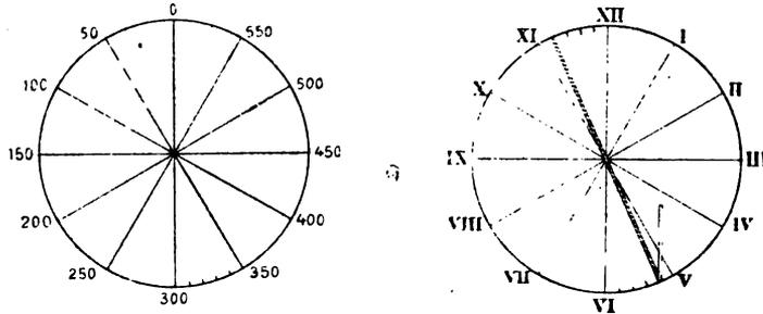
Il ventaglio che si ottiene con questo metodo, pecca per la poca esattezza, particolarmente quando l'operatore è poco esercitato; perciò, secondo l'Autore, quest'ultimo sistema si deve impiegare solo come ripiego quando cioè non si abbia a disposizione il goniometro del comandante di batteria.
