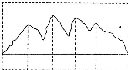
Questo diagramma dimostra che lo sforzo di trazione non è continuo, ma continuamente vario, come varia è la resistenza della strada. E che la resistenza vari, non solo quando il fondo è in pendenza, o fangoso, o polveroso, o molle, ma vari anche per ogni singolo sasso, per il più piccolo rialzo o avvallamento, ben lo sa chi ha pratica della bicicletta.
