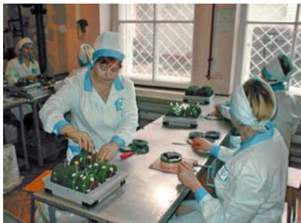
Fig. 5.1: Disassemblaggio manuale di mina antiuomo (Donetsk, Ukraina)
