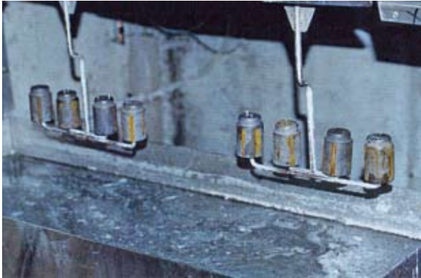
Fig. 5.4: Impianto per la frammentazione criogenica presso Alsetex, Francia (per gentile concessione NAMSA)
