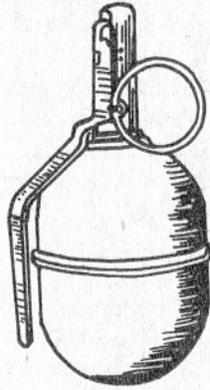
Bild 1 Angriffshandgranate RGD-5 mit eingeschraubtem Zünder
