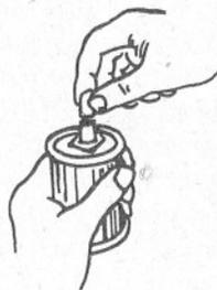
Bild 6 Abschrauben der Verschußschraube
