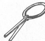
Bild 19 Sicherungssplint mit Ring
