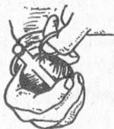
Bild 4 Herausziehen des Sicherungssplintes aus dem Zünder
