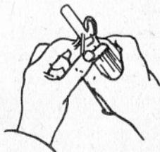
Bild 9 Zusammenbiegen der Enden des Sicherungssplintes
